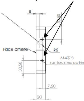
Exemple de fixation tenant compte des profondeurs des trous en périphérie, de l'épaisseur du matériau. Nota : prévoir de se fixer sur 2 cotés pour une meilleure tenue mécanique du produit.
